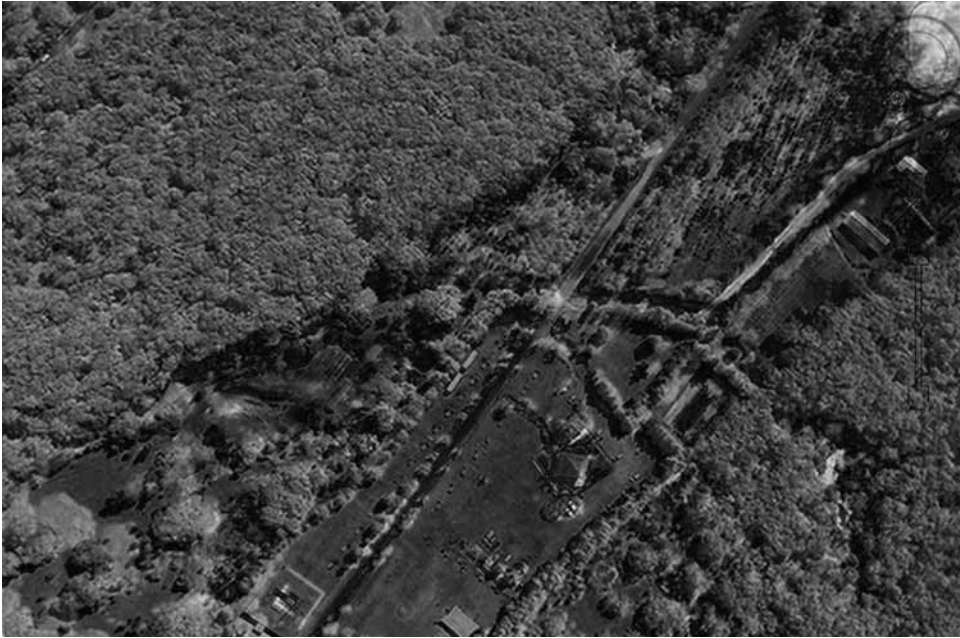
Foto 3. Foto exclusivamente infrarroja procesada de las dos anteriores. Se aprecian algunos colores que representan aberraciones por la falta de alineación perfecta entre ambas fotos.
