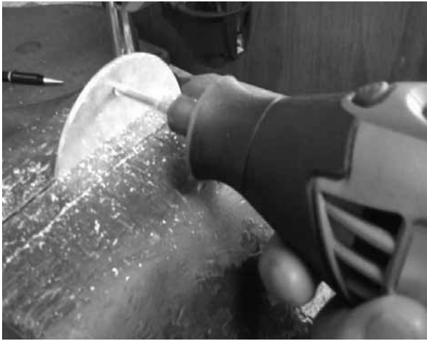
Figura 2. Perforación y lijado de las placas de aluminio.
