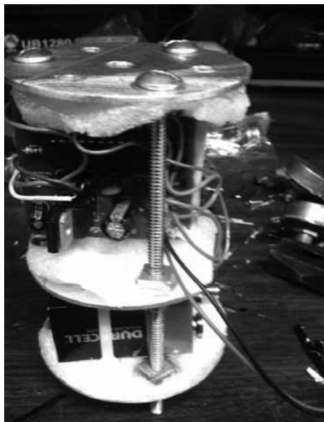
Figura 3: Distribución final del Cansat con hule espuma
