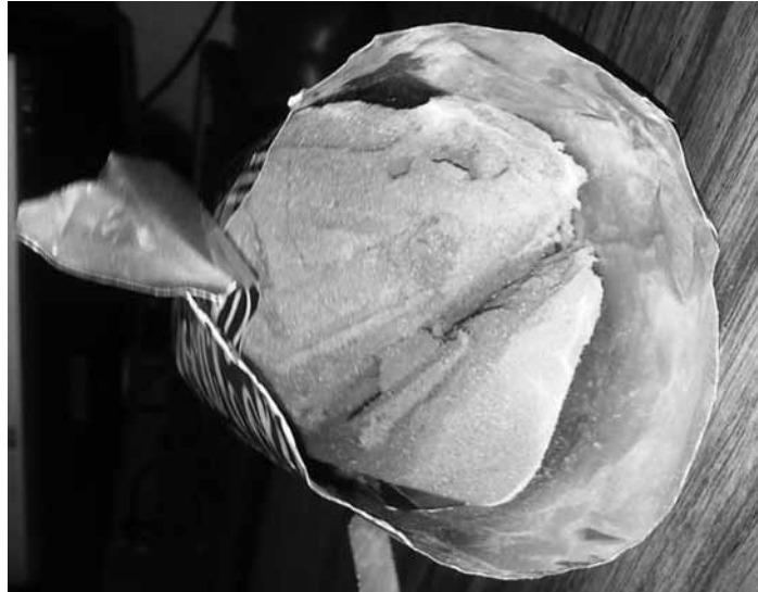
Figura 1. Lata con esponja después de una prueba de resistencia a caídas.
