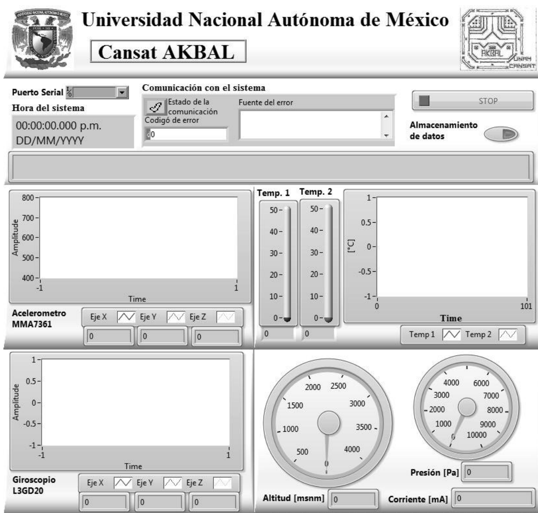
Figura 35: GUI en LabVIEW para la visualización y almacenamiento de datos de Akbal
