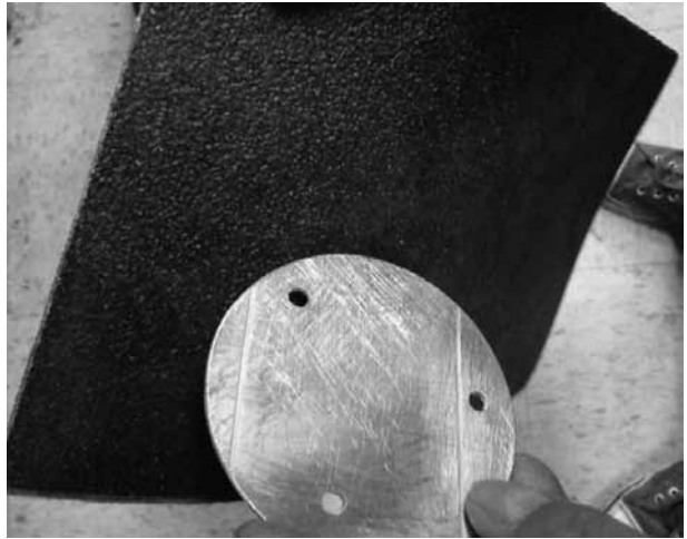
Figura 2. Perforación y lijado de las placas de aluminio.
